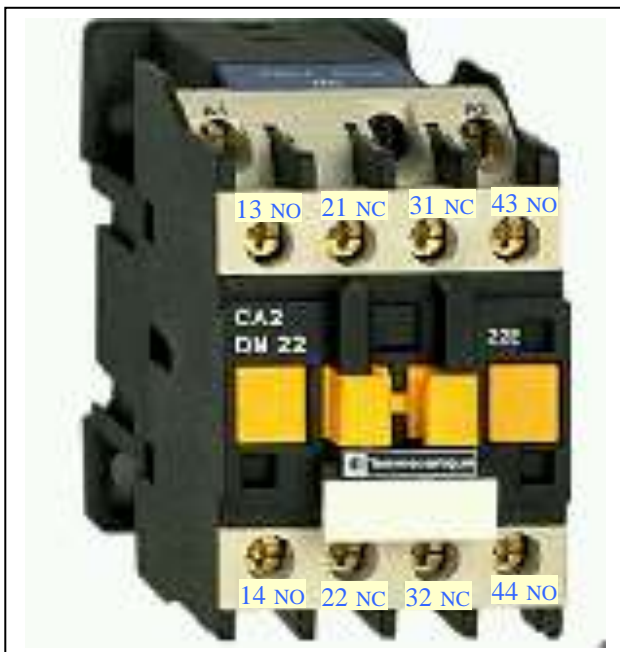
Contacteur auxiliaire de type Telemecanique CA2 DN 22 0 pôles de puissance et 4 contacts de commande 2 à fermeture (NO) 13-14 et 43-44, 2 à ouverture (NC) 21-22 et 31-32
