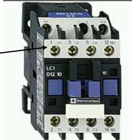
Contacteur de type Telemecanique LC1 D12 10 3 pôles de puissance 1-2, 3-4, 5-6 et un contact de commande à fermeture (NO) 13-14
